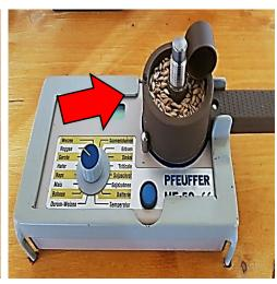
Mit diesem Gerät können die Getreideähren entspelzt werden. Für die Probe werden ca. 10 Ähren benötigt. Der Messvorgang dauert weniger lang, wenn die Ähren auf dem Feld ausgerieben werden und nur die Kernen mitgebracht werden. (Dinkel kann im Spelz gemessen werden) Die Messkammer des Gerätes gleichmässig mit dem Messbecher füllen.
